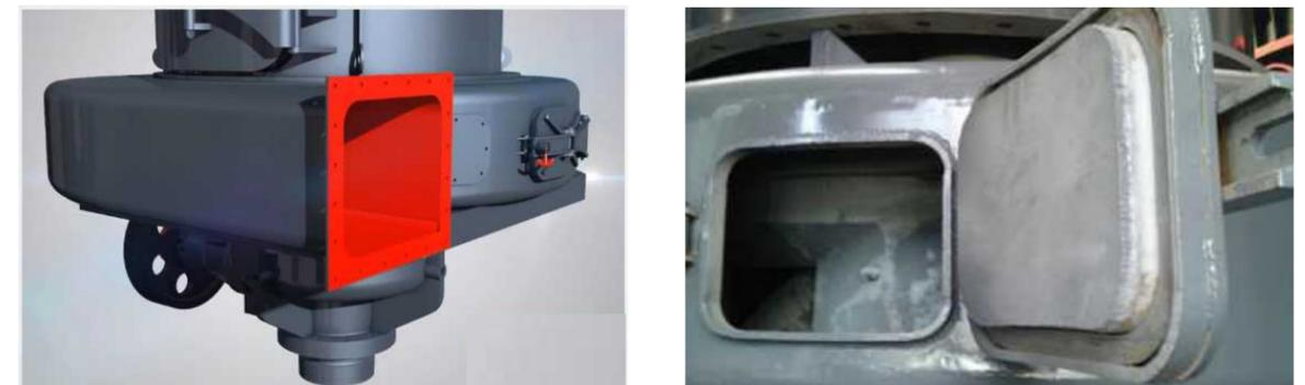
**4)Diseño de estructura especial de rodillo de molienda, anillo de molienda y hoja de pala, utilizando material de alta resistencia al desgaste.**
